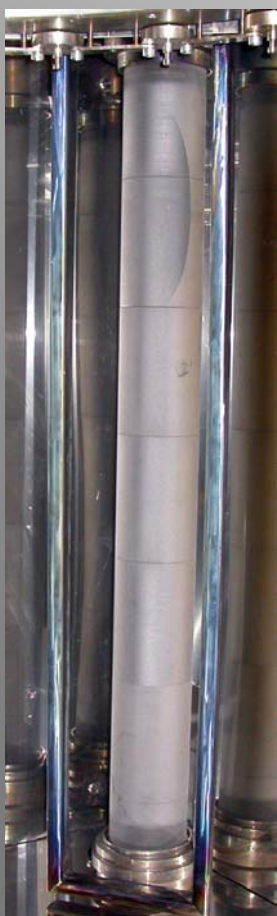
Протяженные магнетроны с вращающимся цилиндрическим катодом длиной до 3 метров
