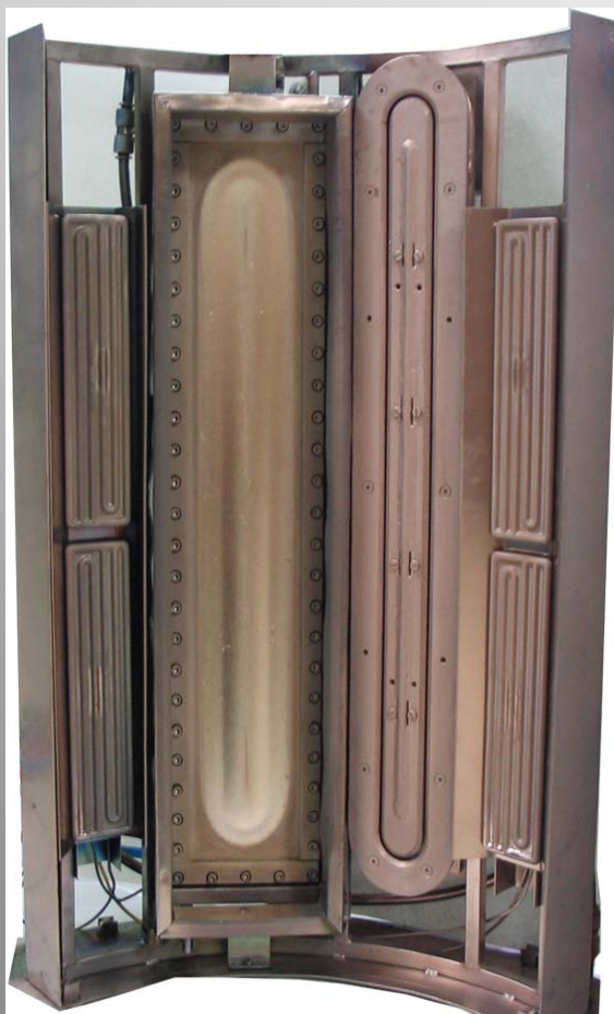
Планарные протяженные магнетроны с прямоугольным катодом длиной до 1 метра
